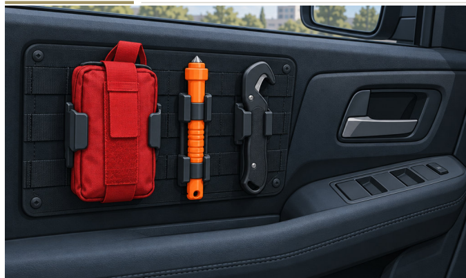
Puerta del conductor: IFAK desprendible, rompevidrios de resorte y cortacinturones de gancho en clips de retención positiva. Ilustración.
